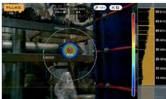
Perdita di vapore rilevata con il Fluke ii910 in un impianto di produzione di alimenti e bevande
