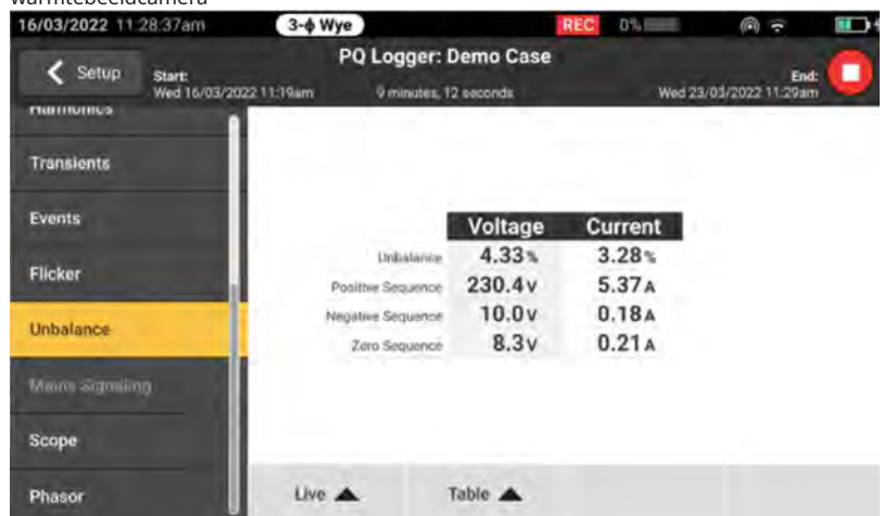
Afbeelding 3: Spannings- en stroomtabel voor onbalans vastgelegd in de Fluke 1777
