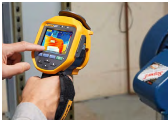
Fluke Ti480 Pro gebruikt voor motorinspecties
