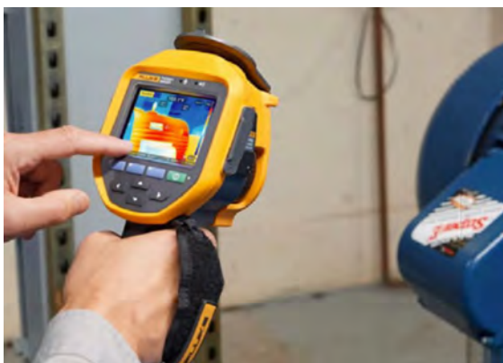
Fluke Ti480 Pro utilisé pour les inspections de moteurs
