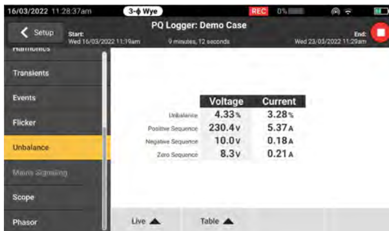
Image 3 : Tableau de tension et de courant de déséquilibre capturé dans le Fluke 1777
