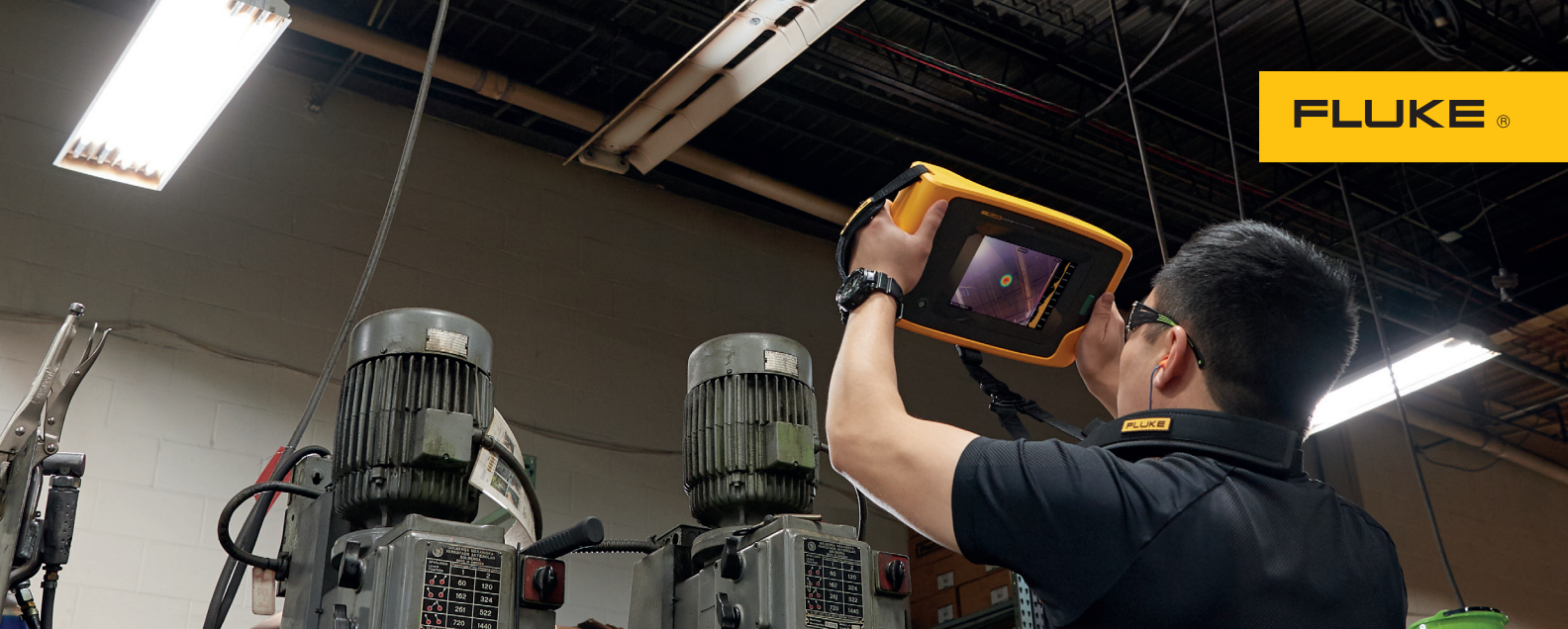
Ispezione delle tubazioni dell'aria compressa con la telecamera acustica industriale Fluke ii900
