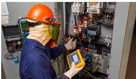
Utilizzando un registratore di rete avanzato Fluke 1738 per eseguire uno studio energetico su un sistema meccanico
